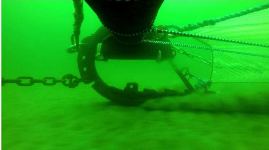
**Abbildung 21: Krabbenbaumkurre im Einsatz mit Blick auf äußeren Kurrschuh. Abbildung aus Mieske (2019b)<sup>26</sup>.**
