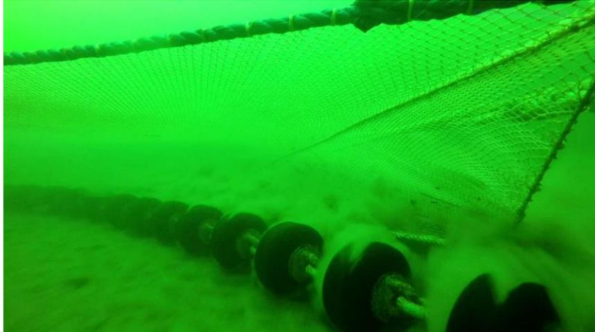
**Abbildung 23: Krabbenbaumkurre im Einsatz mit Blick von der äußeren Grundkette in die Netzmitte. Abbildung aus Mieske (2019b)<sup>11</sup>.**
