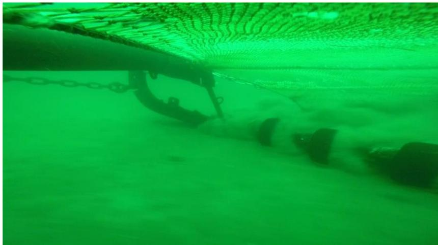
**Abbildung 22: Krabbenbaumkurre im Einsatz mit Kurrschuh und äußerer Grundkette mit Rollen (*bobbins*). Abbildung aus Mieske (2019a)<sup>27</sup>.**
